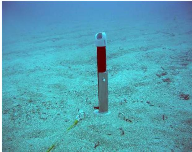
► Correntímetro doppler, velocidad y dirección .
