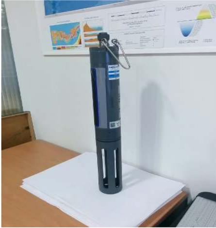
► Sonda multiparamétrica para oxígeno, conductividad y temperatura.
