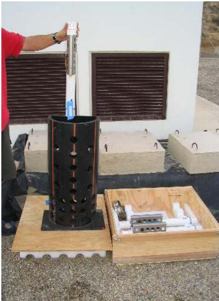
► Conductímetro medición en continuo con defensas para fondeo.
